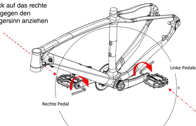
Mit Blick auf das linke Pedal: im Uhrzeigersinn anziehen
