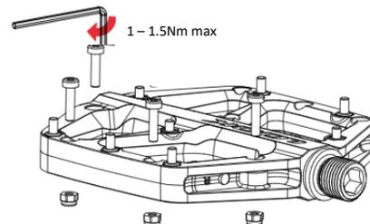
**Attention:** Si vous êtes amenés à démonter vos picots, utiliser une clé Torx T10 et respecter un couple de serrage de 1 – 1.5Nm maximum. Avant le serrage/desserrage, veiller à ce que les empreintes soient propres.
