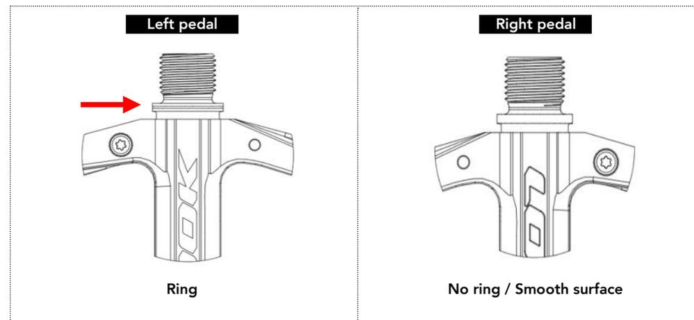
**B / TIGHTENING THE PEDAL ON THE CRANK ARM**
