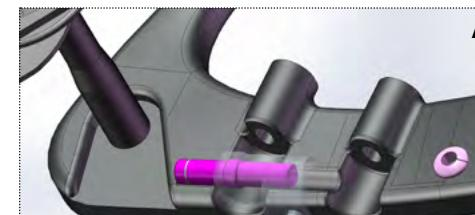
El sensor instalado en el cuadro, en la puntera trasera izquierda (**A**), y el imán instalado en la rueda, en el disco de freno, pueden dañarse al colocar la bici en algunos soportes para bicis (fijación a la horquilla o determinados aparcabicis). Coloque siempre la bici con precaución y evite cualquier contacto con la parte trasera del cuadro y de la rueda durante su almacenamiento y mantenimiento.
