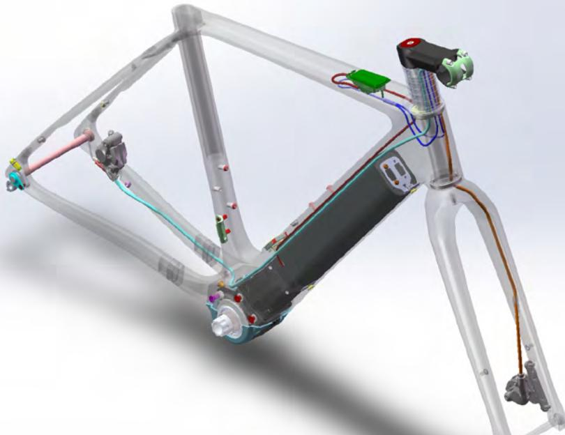
**1 -** Per assemblare il telaio, è preferibile tenerlo per il tubo sella con una coppia di serraggio di 7 Nm. Inizialmente, il telaio dovrebbe essere privo di componenti per facilitare l'accesso attraverso l'headset e il movimento centrale, consentendoti di posizionare il tubo del freno a disco posteriore. Utilizza tubi in schiuma di lunghezza 510 mm per ogni tubo del freno per limitare il rumore nel tubo obliquo.
