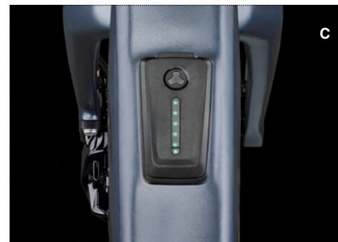
Si el LED HUB está apagado, la asistencia de la bici está desactivada, o el LED HUB está fallando.
