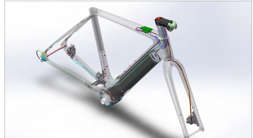
**1** - Al proceder a montar el cuadro, es conveniente sujetarlo por la tija de sillín, apretándola hasta 7 Nm. El cuadro debe estar desnudo para facilitar el acceso por la dirección y la caja de pedalier, permitiéndole guiar los cables a lo largo del tubo diagonal (imagen 1) hasta el desviador, el cambio y el freno de disco trasero. Coloque un canuto de gomaespuma de 510 mm a cada funda de cambio y al latiguillo de freno, para evitar ruidos.
