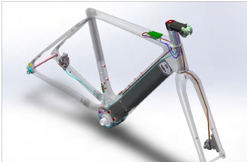
**1** - Al proceder a montar el cuadro, es conveniente sujetarlo por la tija de sillín, apretándola hasta 7 Nm. El cuadro debe estar desnudo para facilitar el acceso por la dirección y la caja de pedalier, permitiéndole guiar el latiguillo de freno trasero. Coloque un canuto de gomaespuma de 510 mm a cada latiguillo de freno para evitar ruidos.
