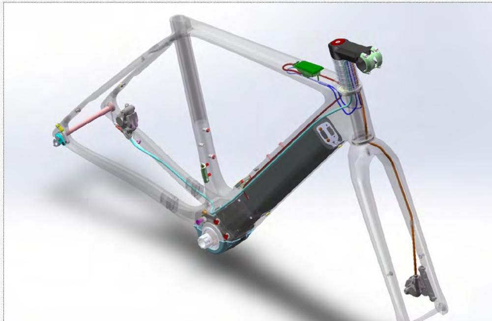
**1** - Afin d'assembler le cadre, il est préférable de le maintenir par la tige de selle au couple de 7Nm. Le cadre doit être nu dans un premier temps, afin de faciliter l'accès par la douille de direction et le boîtier de pédalier, ceci afin de placer la gaine du frein à disque arrière. Prévoir des tubes mousse d'une longueur de 510mm pour chacune des durites de freins afin de limiter toutes nuisances sonores dans le tube diagonal.
