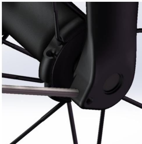
Montare le aste sul parafango utilizzando il controdado di base all'esterno e la vite TBHC M4x8 e la rondella all'interno del parafango.
