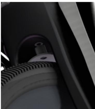
Fissare il parafango alla parte posteriore del tubo sella con la vite CHX M5x20.
