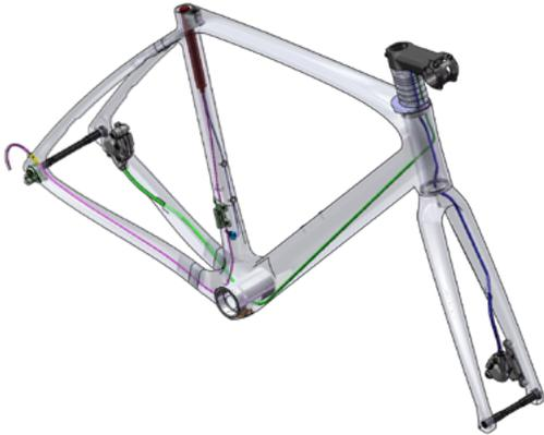
**1** - Afin d'assembler le cadre il est impératif de maintenir par la tige de selle au couple de 7Nm. Le cadre doit être nu dans un premier temps afin de faciliter l'accès par la douille de direction et le boîtier de pédalier, ceci afin de placer les gaines et les fils électriques selon les préconisations Shimano de la batterie dans la tige de selle jusqu'aux dérailleurs avant et arrière puis celle du frein à disque arrière. Insérer un tube mousse sur la durite arrière d'une longueur de 510mm.
