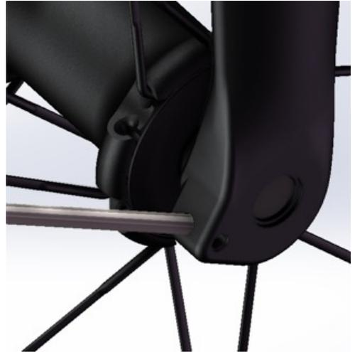
Coloque las varillas del guardabarros sobre la base de la tuerca exterior y el tornillo y la arandela TBHC M4x8 en el interior del guardabarros.
