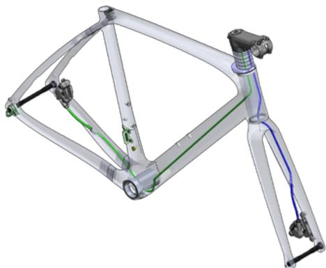
**3** - De même pour la fourche, la durite de frein avant doit passer dans le trou sur le pivot de direction puis faites-la sortir au niveau de la branche, si l'étrier de frein est pré-routé avec sa durite alors passer par le trou au niveau de la branche et sortez par l'ouverture du pivot de fourche.
