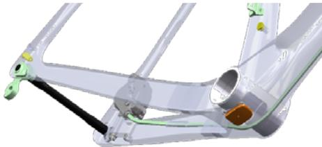
**2** - Wie bei den anderen Modellen empfehlen wir, die hintere Bremsleitung durch die linke Kettenstrebe zu führen, dann über das Tretlager und das Unterrohr nach oben zu verlegen und dann den gleichen Weg durch den Steuersatz (oberes Lager und Distanzstücke) zum Lenker zu nehmen.
