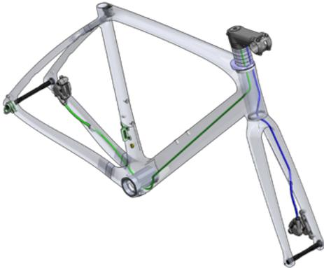
**1** - Für den Zusammenbau des Fahrrads benötigen Sie einen Montageständer. Es ist wichtig, den Rahmen an der Sattelstütze zu befestigen und mit einem Drehmoment von 7 Nm festzuziehen. Der Rahmen muss demontiert werden, um den Zugang zum Steuersatz und zum Tretlager zu erleichtern, damit Sie die hintere Bremsleitung verlegen können. Verwenden Sie ein 510 mm langes Schaumstoffrohr für den hinteren Bremschlauch, um unerwünschte Geräusche im Unterrohr zu vermeiden.
