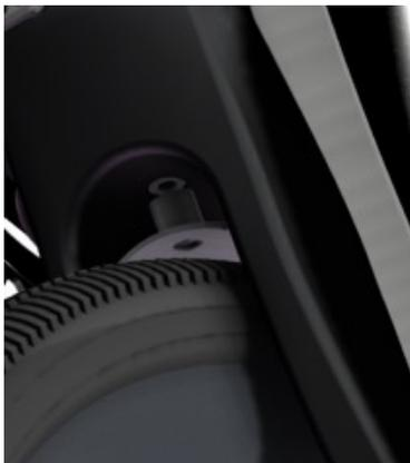
Befestigen Sie das Schutzblech mit der Schraube CHX M5x20 an der Rückseite des Sitzrohrs.
