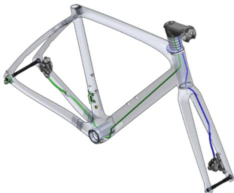
**1** - Per assemblare la bicicletta è necessario un cavalletto da officina. È importante fissare il telaio al reggisella, serrando con una coppia di 7Nm. Il telaio deve essere smontato per consentire un facile accesso alla serie sterzo e al movimento centrale, in modo da poter passare il tubo del freno posteriore. Utilizzate un tubo in foam lungo 510 mm sul tubo del freno posteriore per eliminare qualsiasi rumore indesiderato nel tubo obliquo.
