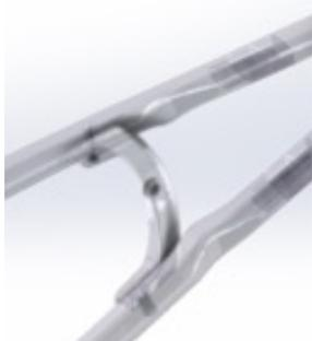
Fissare il parafango al telaio sul retro del movimento centrale utilizzando il distanziale  $\varnothing 12$ , lunghezza 15, e la vite CHC M5x30.
