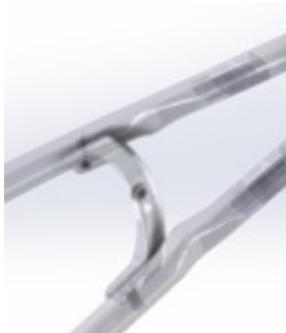
Asegure el guardabarros al cuadro por detrás de la caja de pedalier con el espaciador  $\varnothing 12$  y 15 mm de grosor, y el tornillo CHC M5x30.
