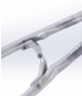
Fixer le garde boue à l'arrière du boitier de pédalier au cadre grâce à l'entretoise  $\varnothing 12$  longueur 15 et la vis CHc M5x30.
