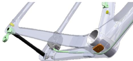
**2** - Al igual que para otros montajes, recomendamos deslizar el latiguillo trasero a lo largo de la vaina izquierda, por encima de la caja de pedalier y subirlo por el tubo diagonal. Después siga la misma trayectoria a través de la dirección hasta el manillar.
