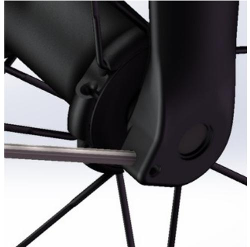
Monter les tringles sur le garde boue avec l'écrou frein à embase à l'extérieur et l'ensemble vis TBHC M4x8 rondelle à l'intérieur du garde boue.
